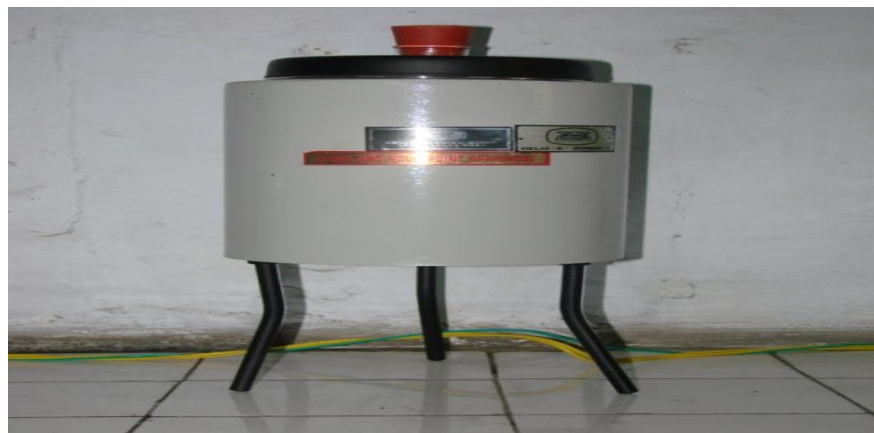
Fig 4.3: Cloud and pour point apparatus [18]
